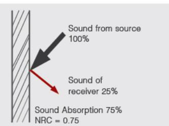
โดยมีปริมาณที่จะแนะนำในการติดตั้ง วัสดุอะคูสติก เอสซีจี สำหรับผนังตกแต่งดูดซับเสียง รุ่น Cylence™ Zandera™ ตั้งต่อไปนี้
